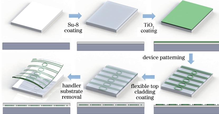
图 5 对柔性光子器件进行单片集成的工艺流程<sup>[87]</sup>
