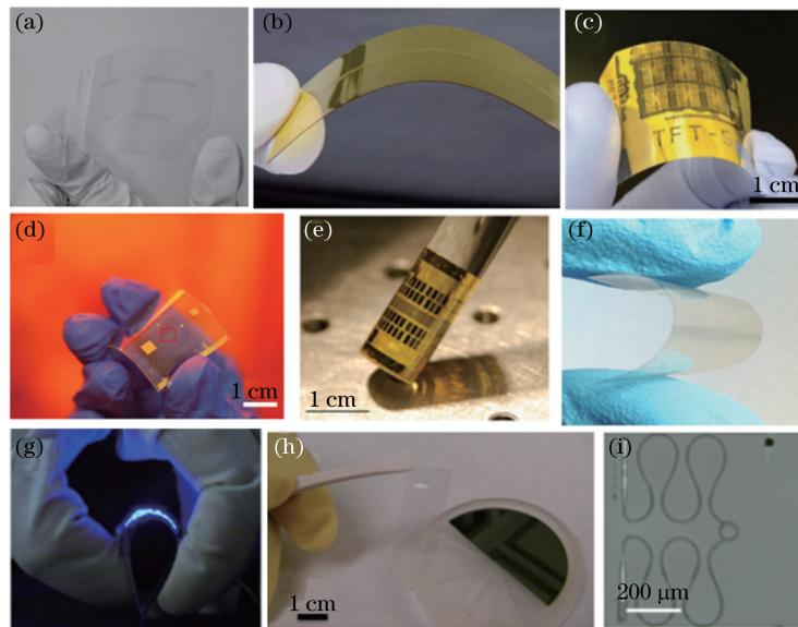
图 1 基于不同材料体系的柔性光子器件。(a)以 PDMS 为包层的柔性聚合物波导<sup>[25]</sup>; (b)以 PI 为包层的柔性光波导<sup>[26]</sup>; (c)柔性 Si NM 光电晶体管<sup>[34]</sup>; (d)基于 PET 的 Ge NM MSM 光电二极管阵列<sup>[75]</sup>; (e)基于 Kapton 胶带的 8×100 InGaAs 薄膜 p-i-n 光电二极管阵列<sup>[43]</sup>; (f)弯曲状态下的 WSe<sub>2</sub> 光电探测器图像<sup>[44]</sup>; (g)LED 在弯曲半径为 3.5 mm 下发射蓝光的照片<sup>[50]</sup>; (h)非晶硅应变传感器<sup>[72]</sup>; (i)可拉伸玻璃波导光学显微镜图<sup>[74]</sup>
