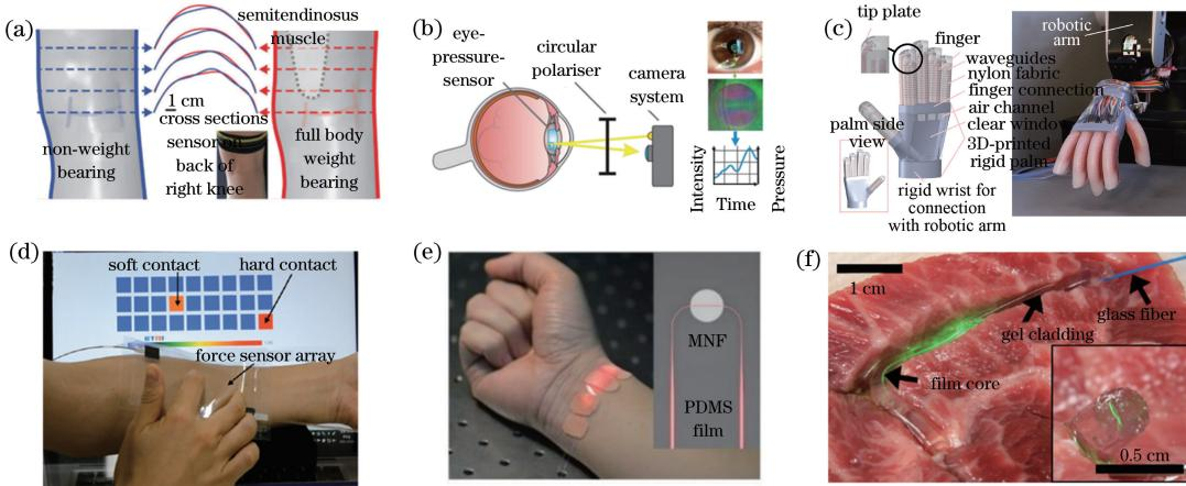
图 7 柔性光子器件在传感领域的应用。(a)用于检测膝关节承重情况的柔性光纤<sup>[127]</sup>;(b)基于布拉格光栅变形来测量眼部压力的传感器<sup>[126]</sup>;(c)用于软体机械手光电应变传感的可拉伸光波导<sup>[123]</sup>;(d)基于聚合物波导的触觉阵列传感器<sup>[122]</sup>;(e)用于光子皮肤传感的柔性微纳光纤<sup>[130]</sup>;(f)用于生物组织中光传输的蚕丝素蛋白柔性光波导<sup>[133]</sup>
