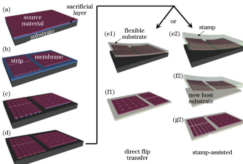
图4 半导体薄膜释放、转移、堆叠在柔性衬底上的通用过程<sup>[85]</sup>
