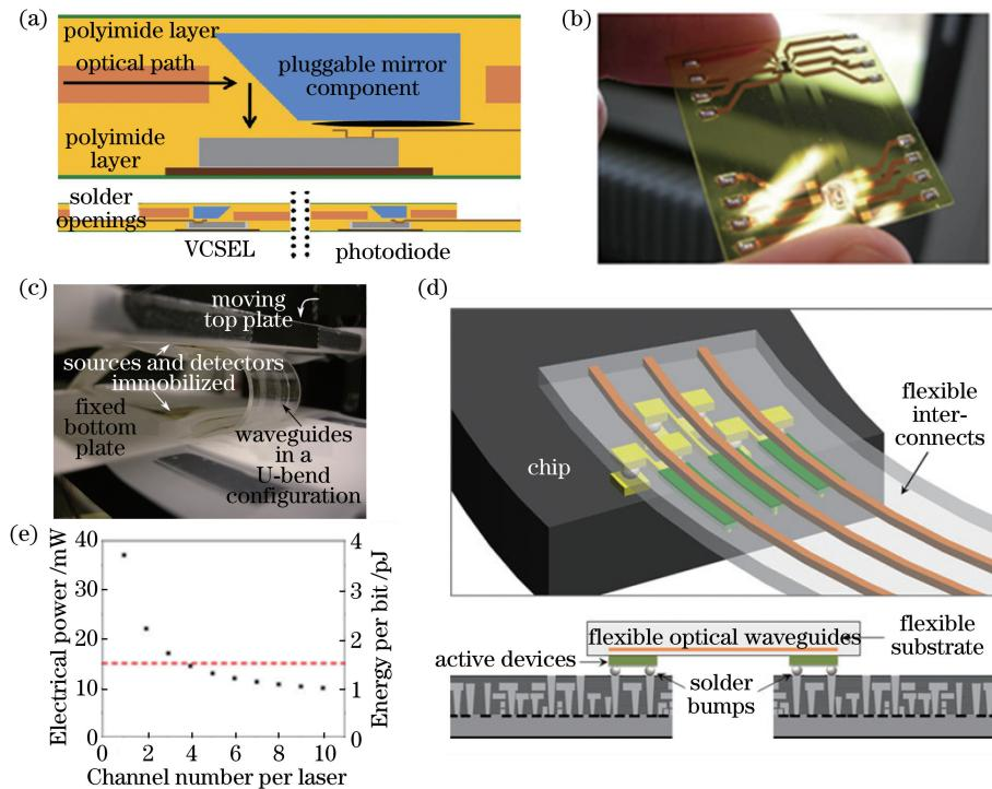
图8 柔性光子器件在光互连领域的应用。包含聚合物波导、反射镜和光电子元件的全嵌入式光学链路的柔性光互连方案的(a)示意图和(b)器件照片图<sup>[151]</sup>; (c)集成光源、探测器和聚合物波导的可拉伸光学链路<sup>[146]</sup>; (d)柔性高折射率差单模波导高密度集成光互连设计方案示意图;(e)图8(d)所示方案与基于VCSEL的多模波导光互连方案的单通道功耗对比<sup>[149]</sup>
