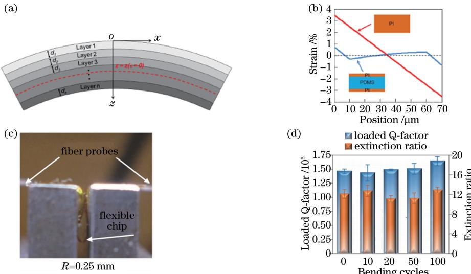
图2 多中性面结构设计。(a) 多层结构的纯弯曲,其顶面和底面分别承受拉伸和压缩应变,中性平面位置由(1)式指定<sup>[85]</sup>;(b)弯曲半径为1 mm的两种薄膜结构中应变分布的有限元模拟结果,蓝色曲线对应于聚酰亚胺(10 μm)-有机硅(50 μm)-聚酰亚胺(10 μm)三层结构中的应变分布,红色曲线表示相同总厚度(70 μm)的单个聚酰亚胺层中的应变分布<sup>[85]</sup>;(c)可折叠的光子器件(弯曲半径小至0.25 mm)<sup>[87]</sup>;(d)光学谐振腔在不同弯曲次数后的品质因子和消光比(弯曲半径为0.5 mm)<sup>[84]</sup>
