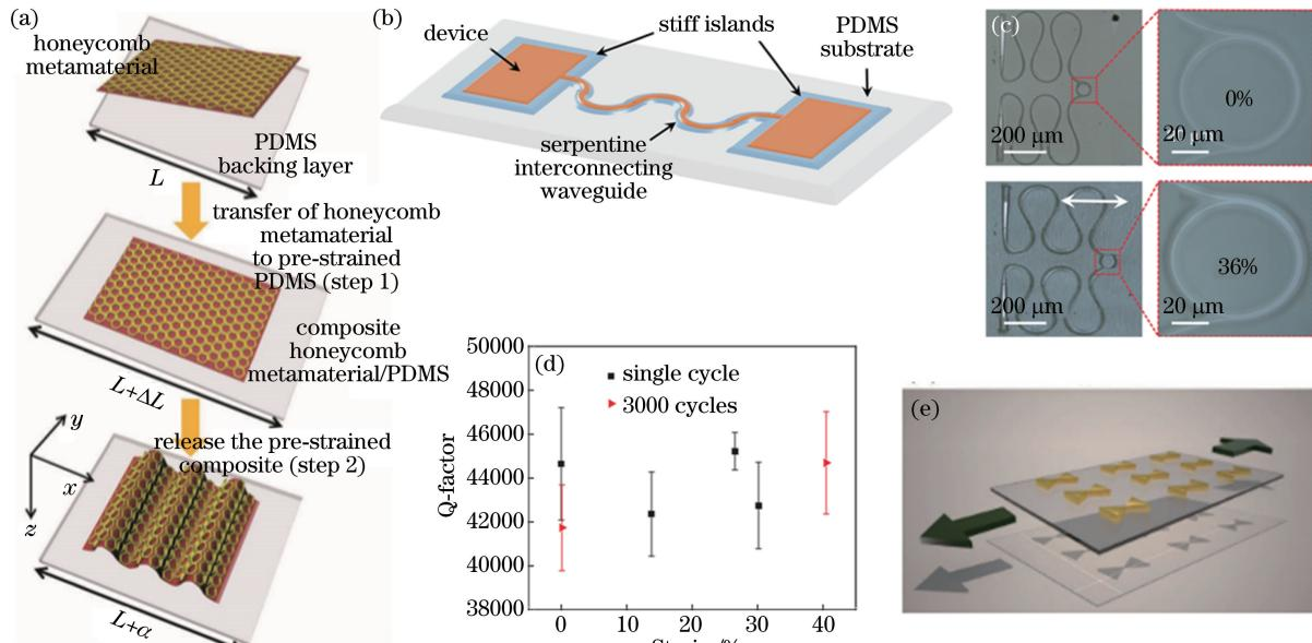
图 3 采用蜿蜒、分立结构制备可拉伸器件。(a) 具有褶皱结构的蜂窝形超材料的制备过程<sup>[91]</sup>；(b) 包含蜿蜒波导和考虑局部硬化的可拉伸集成光子器件设计示意图<sup>[96]</sup>；(c) 波导耦合微环谐振腔在拉伸前后(未拉伸和 36% 拉伸)的光学显微镜图<sup>[96]</sup>；(d) 3000 次 42% 重复拉伸前后的光学损耗表征<sup>[96]</sup>；(e) 基于金有源层和 PDMS 衬底的柔性蝴蝶形纳米天线阵列超材料薄膜<sup>[97]</sup>
