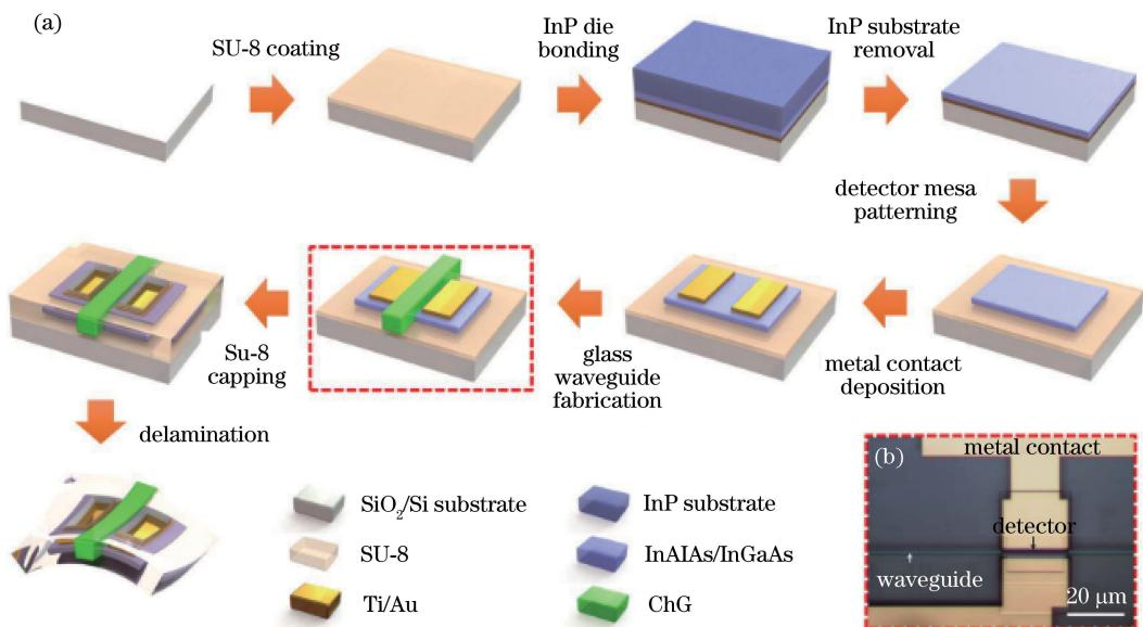
图 6 柔性光子器件混合集成工艺。(a)柔性波导集成探测器制备流程图<sup>[88]</sup>;(b)柔性波导集成探测器光学显微图<sup>[88]</sup>
