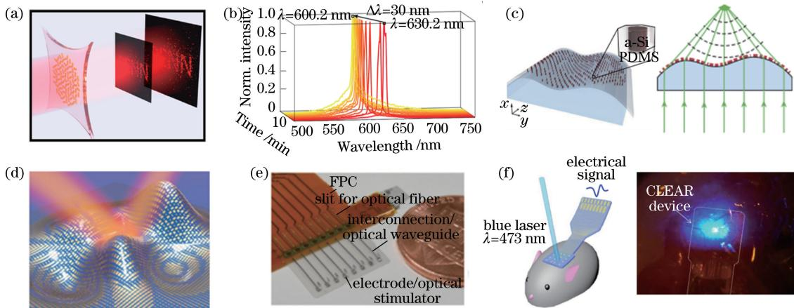
图 9 柔性光子器件在新型光场调控领域的应用。(a)可拉伸超表面结构实现多个全息图片的连续可重构切换<sup>[156]</sup>;(b)可拉伸布拉格光栅实现波长可调有机半导体分布式反馈(DFB)激光器<sup>[158]</sup>;(c)与具有任意几何形状的透明物体共形的介电超表面结构示意图<sup>[160]</sup>;(d)超表面皮肤隐身衣的3D图,由一层超薄的纳米天线(金块)组成,可覆盖在任意形状的物体上<sup>[161]</sup>;(e)用聚合物基FPC封装的微尺度光源与微电极波导阵列<sup>[163]</sup>;(f)柔性光纤植入老鼠大脑皮层,用蓝光刺激神经细胞和进行皮层血管成像的装置和实验图<sup>[4]</sup>
